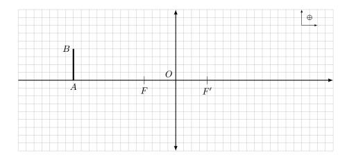
(b) Objet réel placé à une distance  $\overline{OA} < f^\prime$
