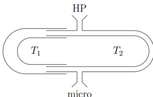
Le trombone de Kœnig est un dispositif de laboratoire permettant de faire interférer deux ondes sonores ayant suivi des chemins différents. Un haut-parleur, alimenté par un générateur basses fréquences, émet un son de fréquence  $f = 1,5 \text{ kHz}$ .
