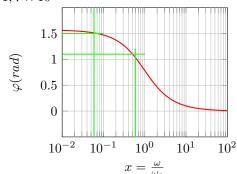
$f_1$ : La pulsation de plus basse fréquence est coupée par le filtre car de trop basse fréquence.
