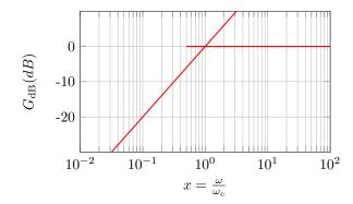
Le diagramme de Bode réel rejoint les asymptotes en basse et haute fréquences et passe par le point d'abscisse x=1 et d'ordonnée -3 dB.
