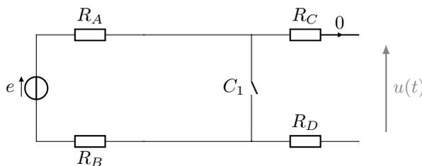
Les intensités sont nulles dans toutes les branches du circuit, les tensions aux bornes des résistances le sont donc aussi. On en déduit donc que  $u(t) = e(t)$ . Le filtre laisse passer.
