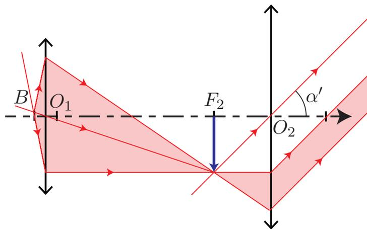
En se plaçant dans le triangle  $A_1B_1O_2$  rectangle en  $A_1$ , on obtient  $\tan \alpha' = \frac{\overline{A_1B_1}}{\overline{O_2A_1}} = -\frac{\overline{A_1B_1}}{f_2}$ . Nous sommes dans les conditions de Gauss, on peut donc écrire  $\tan \alpha' \approx \alpha'$ , d'où,  $\alpha' = -\frac{\overline{A_1B_1}}{f_2}$ .
