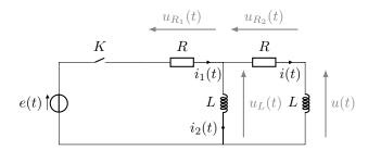
Considérons le cas où la tension fournie par le générateur soit sinusoïdale. On utilise alors les notations complexes  $\underline{e}$  et  $\underline{i}$  associées à la tension fournie par le générateur et à l'intensité i.
