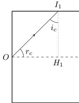
Le trajet le plus long est effectué pour  $\theta = \theta_0$ , la distance parcourue entre l'entrée et la première réflexion est donc  $\ell_1 = \frac{OH_1}{\cos r_c}$  où  $r_c$  est l'angle de réfraction à l'entrée dans la fibre correspondant à une réflexion totale à l'interface cœur / gaine. On en déduit ainsi :
