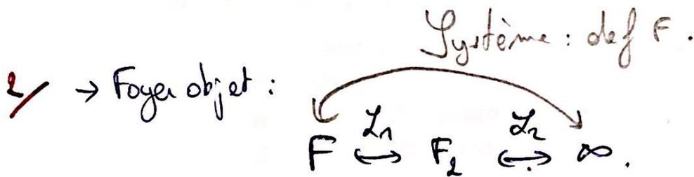
Le foyer objet se pour image l'infini par le système. Cette image correspond donc à une image intermédiaire en  $F_2$  car  $L_2$  conjugue  $F_2$  et l'infini par définition du foyer objet.
