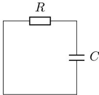
On considère un condensateur chargé à une tension  $E$  que l'on insère à  $t = 0$  dans le circuit ci-contre. Faire l'étude complète de sa décharge (équation différentielle, résolution, tracé de  $u_c$  et bilan énergétique).
