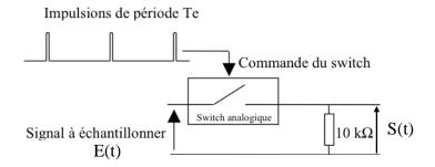
L'interrupteur commandé bilatéral (le switch) est fermé lorsque l'on soumet la commande du switch à une tension positive, ouvert pour une tension nulle.
