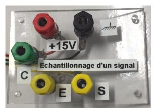
Après vérification des deux signaux, les placer à l'entrée de la plaquette et visualiser simultanément à l'oscilloscope les signaux E(t) et S(t).
